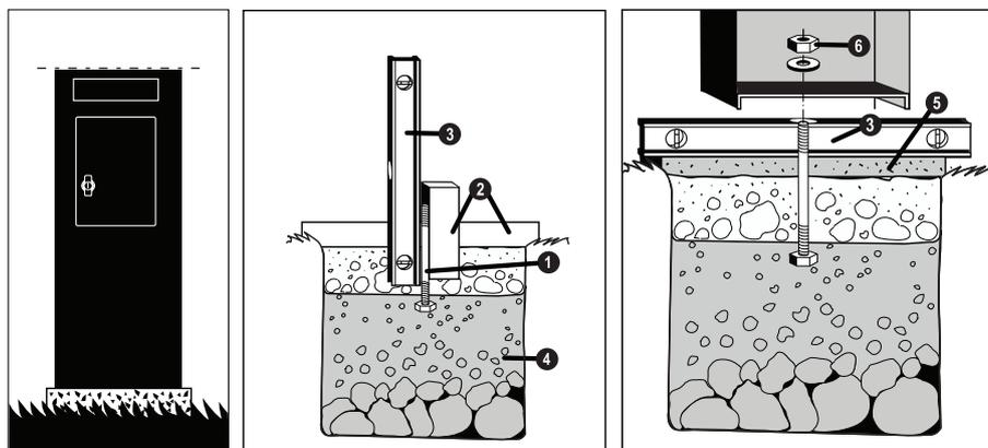
Die Bodenbefestigungsteile sind beigefügt
